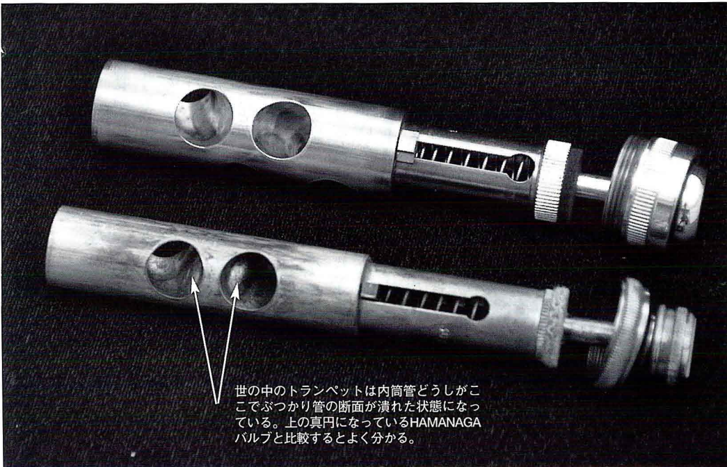
濱永さんのトランペットはピストンの内筒管がクロスする部分でも完璧な真円になっている。世の中のトランペットでは左写真の矢印の部分で内筒管どうしが干渉し合い、円が潰れたような状態になっている。断面積が真円かそうでないかで楽器の鳴りの効率の良さは大きく変わると濱永さんは強調する。
